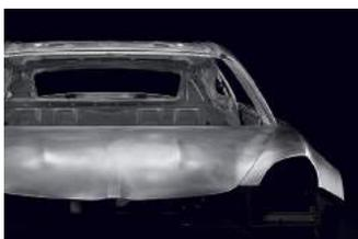
新型A110のボディの96%がアルミ製で、4%が樹脂製。現代のテクノロジーにより、総重量を1100kgに取め、軽量化を実現している
