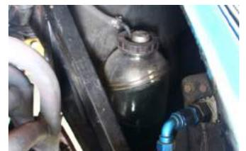
オリジナルパーツであるガラス製のエンジン冷却水リザーブタンクも現存。大切に乗り継がれていることが窺える
