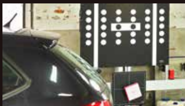
自動ブレーキ装着車を修理する際に必要なケースがある各種カメラ・センサー類の機能調整「エーミング」。同社でも各メーカーの対応に乗り出している
