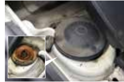
高年式型から樹脂力バーが装着されたが、外してみるとサビが!
