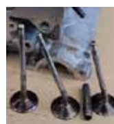
タイミングベルトが切れてピストンとぶつかり曲がってしまったバルブ
