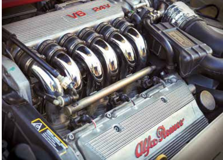
すでに樹脂カバーで覆われたエンジンルームが増えていた発売当時、インテークパイプが魅惑的な輝きを放った2.5L・V6エンジン
