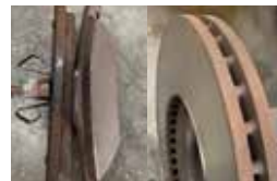
摩耗したブレーキパッド(左)とローター(右)
