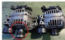
左側が外したオルタネーター。プーリーの部分が飛び出している
