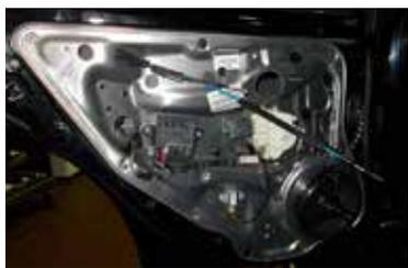
先日、メルセデスCクラス (W204) で「リアドアのドアロックが左右共に作動しない」という症状で入庫。テスターで診断してみると故障メモリの入力は無のものの、リアドアのコントロールユニット内のドアロックの実測値では左右共に「メカニカルエラー」という表示が出ていたので、
