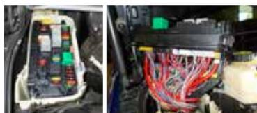
こうして、このユニットとリアのドアロックが、つながっている事を確認しました。この後、フロントSAMコントロールユニットのソフトウェアが古いバージョンになっていたため、最新バージョンにアップデート。無事にリアのドアロックが正常に作動するようになりました。
