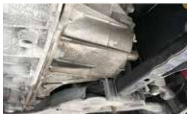
平成24年式、6.6万km走行のルノーメガーヌ。走行中にミッションマウントのボルトが折れてミッションが脱落。その際に、左ドライブシャフトのインナージョイントが抜け走行不能に。脱落したミッションは、メンバーの上に乗っかっていました。左ドライブシャフトのインナージョイントがブーツ内部で抜け空転したため、ブーツが
