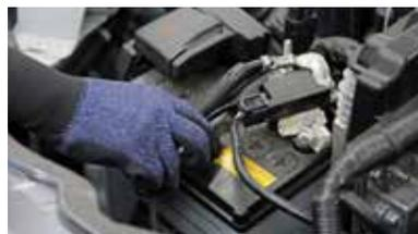
在のバッテリー残量に合わせた充電制御を行っている。そのため、新しいバッテリーが車両に取り付けられたことを車両に伝えなければならない。
