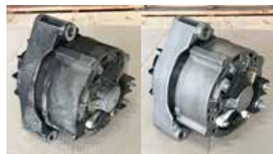
ベント用オルタネーター(左)リビルト後(右)リビルト前
