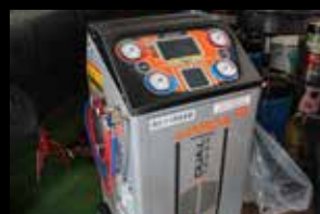
新冷媒R1234-yflにも対応できる回収機
